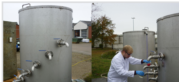
Darstellung eines halbtechnischen Versuchsfilters mit Probenahmestellen in verschiedenen Filterschichten (li.), Probenahme aus einem halbtechnischen Versuchsfilter (re.). © Sören Hornig/ISWW
