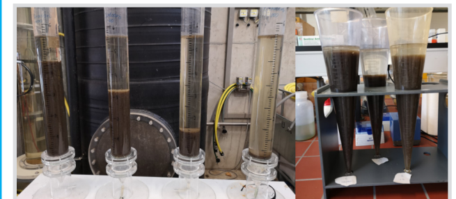
Aufbau der Absetzversuche zur Untersuchung des Absetzverhaltens von Belebtschlamm. © ISAH
